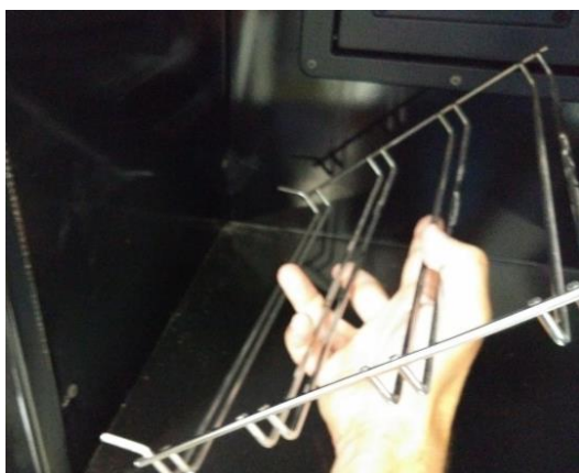
Figura n°22 - Retirada de los soportes de varillas.
