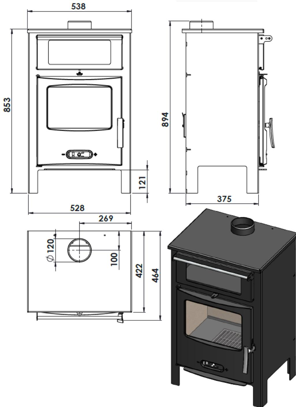
Figura n°3 - Dimensiones en mm del aparato Sagra CH
