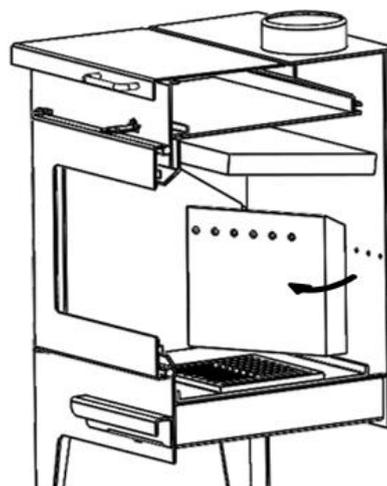
Figura n°16 - Extraer la vermiculita trasera derecha
