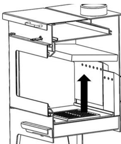
Figura n°14 - Elevar la vermiculita trasera izquierda
