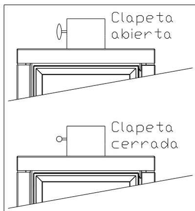
Figura nº6 - Sistema manual seccionador de paso de humos
