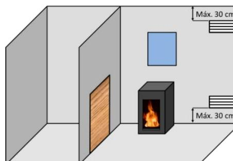
Figura nº4 - Esquema orientativo para rejillas de ventilación
