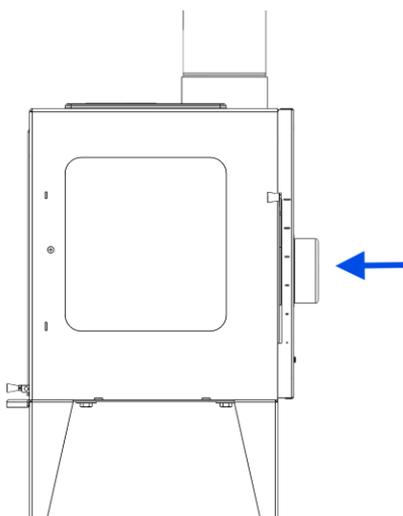
*Figura nº4 - Conducción de aire para cámara de combustión*
