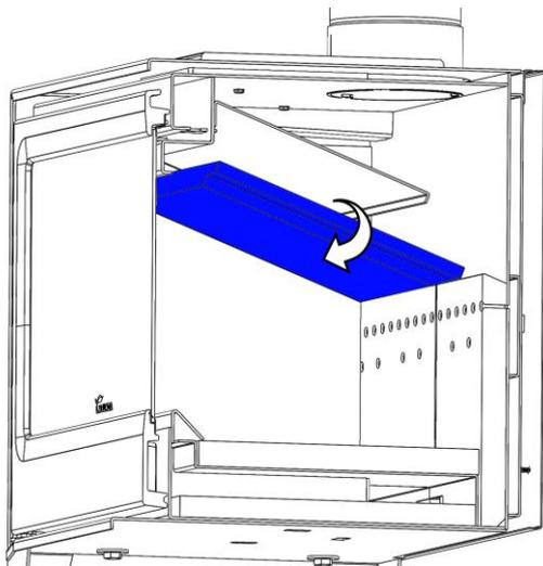
*Figura n°15 - Retirar vermiculita*
