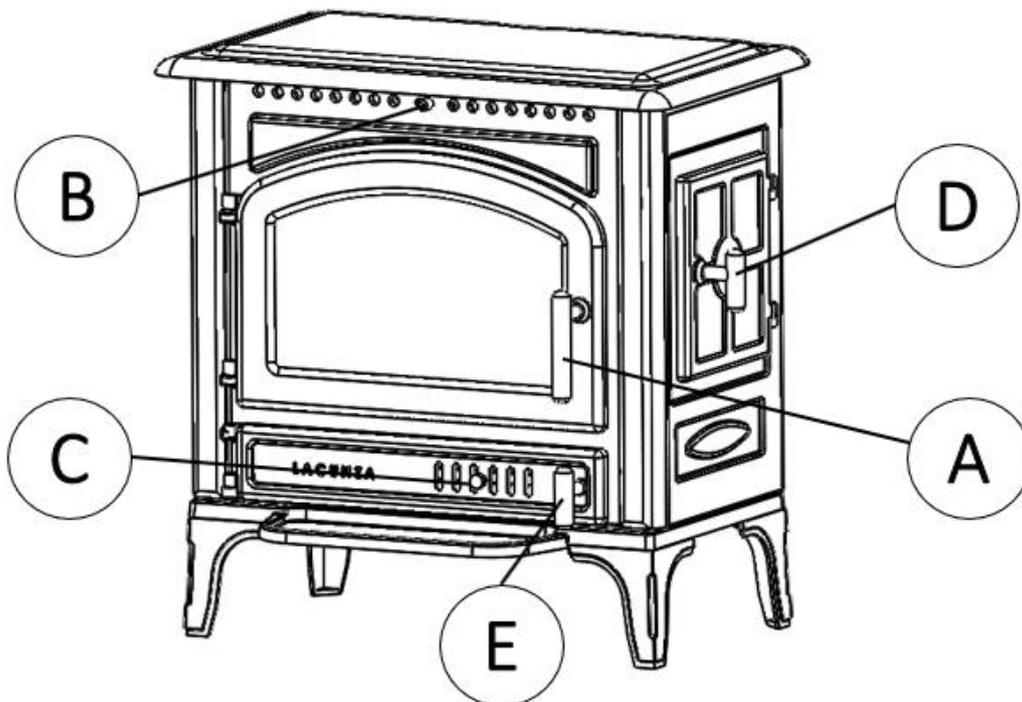
Figura nº9 - Elementos de funcionamiento del aparato
