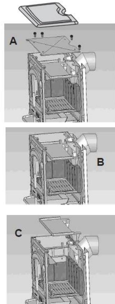
Figura nº10 - Desmontaje del deflector
