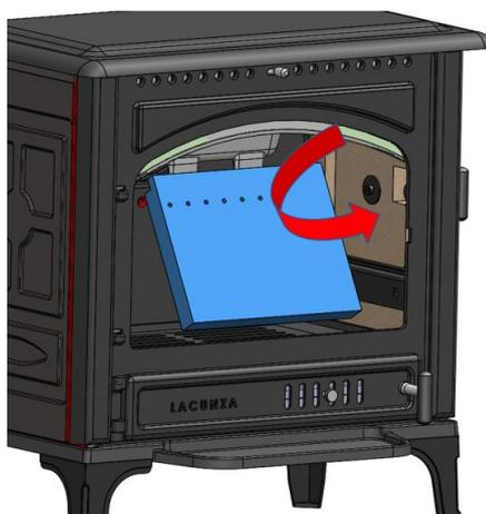
Figura nº11 - *Secuencia de extracción vermiculitas traseras*
