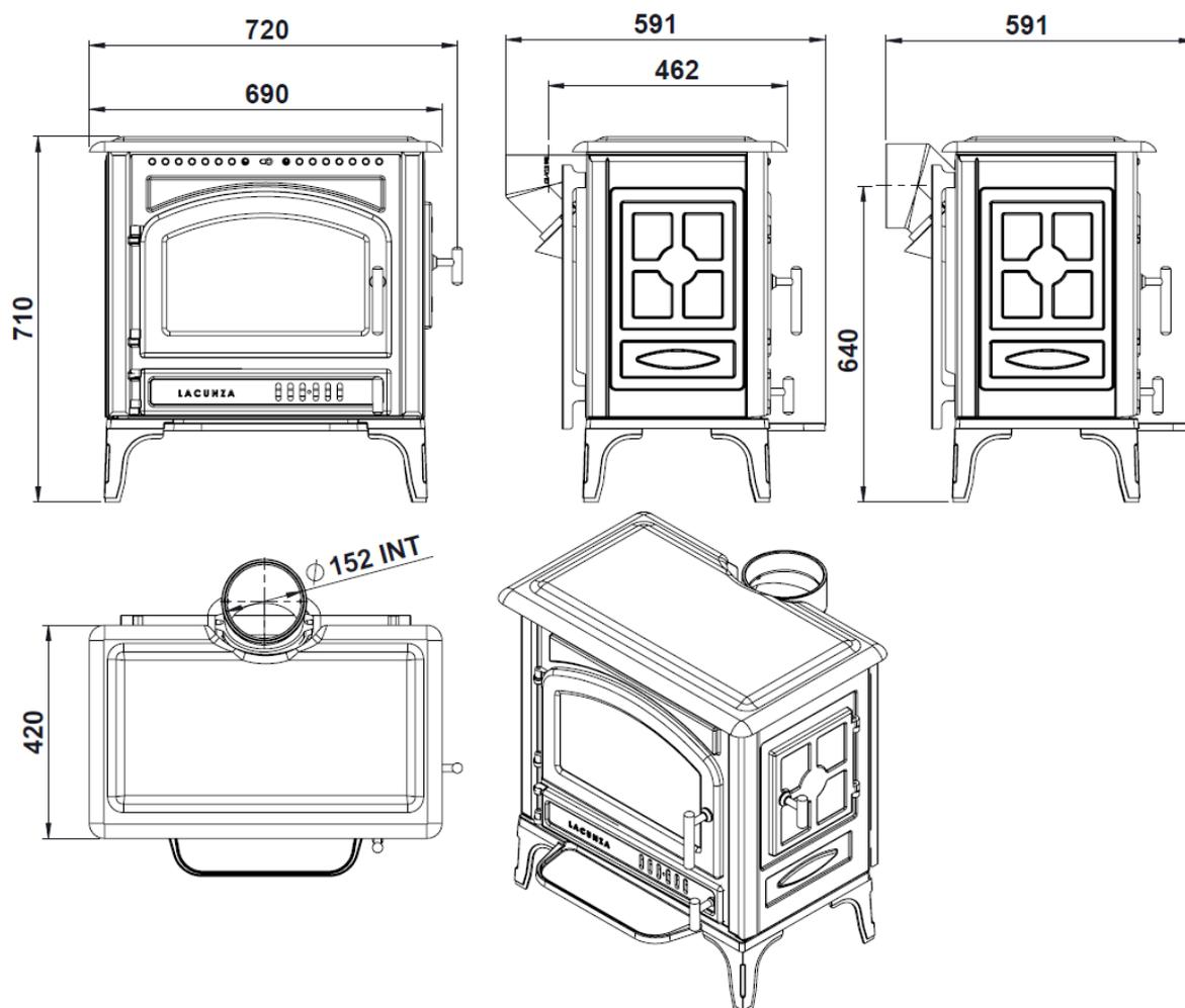
Figura nº1 - Dimensiones en mm del aparato Levante
