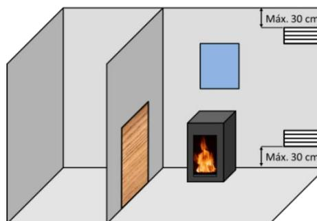
Figura nº2 - Esquema orientativo para rejillas de ventilación
