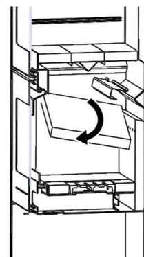
Figura n°15 - Extracción de los deflectores de vermiculita
