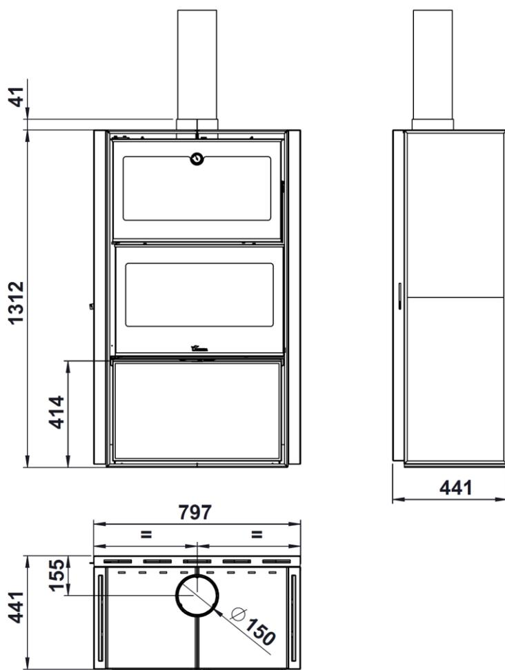
Figura n<sup>o</sup>1 - Dimensiones en mm del aparato BERGEN
