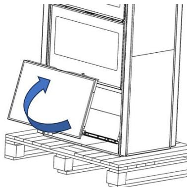
*Figura nº2 - Detalle de la extracción del cajón*
