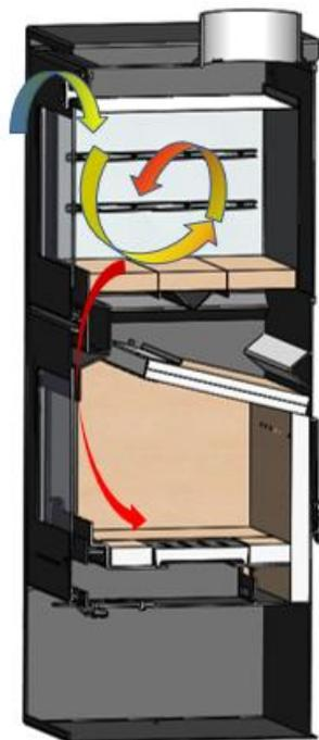
*Figura n°9 - Esquema del sistema de extracción de vahos*
