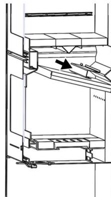
Figura n°14 - Refuerzo sobre los deflectores de vermiculita
