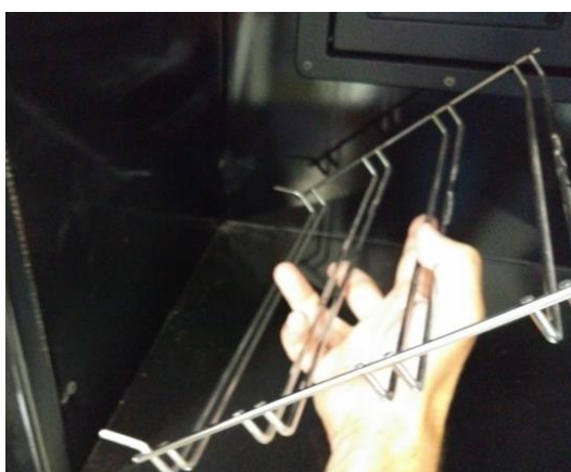
Figura n°21 - Retirada de los soportes de varillas.
